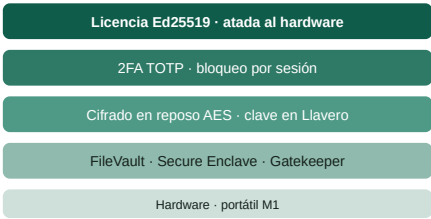
Figura 4. Cadena de confianza. Cada capa se apoya en la inferior; el cifrado de la aplicación se ancla en la seguridad de plataforma del propio Mac, y la licencia queda ligada al identificador de hardware.
